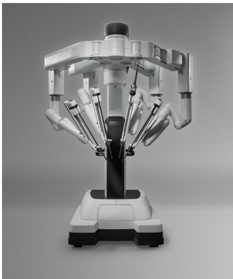
Figuras 5 y 6. Carro de visión da Vinci Xi ® Surgical System, Intuitive Surgical.
